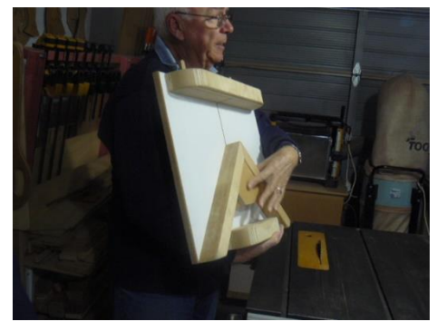
Photo 9 a sledge for cutting mitres
